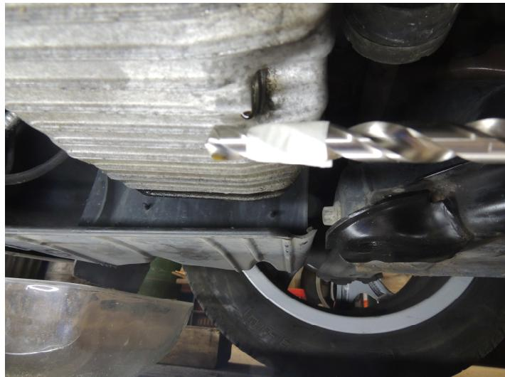
Enduire copieusement le foret de graisse (permet de retenir les copeaux) et percer le carter
