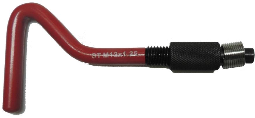
Aspirez les copeaux restants dans le filetage et dégraissez celui ci
