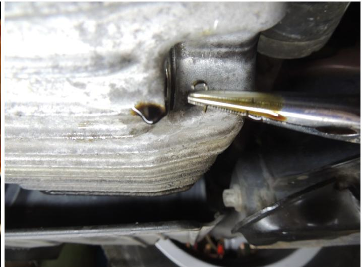
L'opération est terminée, Remontez le bouchon de vidange avec un joint neuf serrez au couple de **1.4 daN.m**
